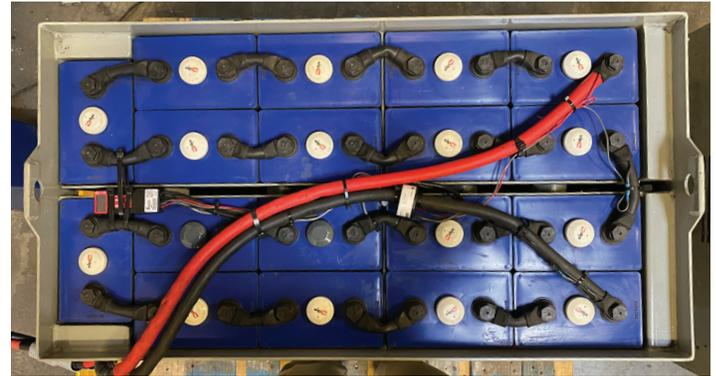
Abbildung 8: Montage des Wi-iQ4 auf Batterie mit 12V-Blocks
