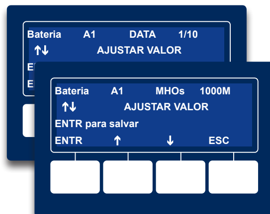
Fig. 3 - Entrada da Data de Fabricação e MHOs da Bateria
